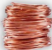
**6. Bobinado, tratamiento térmico y limpieza:** Para obtener el tubo recocido, se procesa en rollos (bobinado) que se someten a un **tratamiento térmico** en un horno de pasaje y atmósfera neutra, a su vez, con este tratamiento se eliminan los restos de lubricantes (limpieza).
