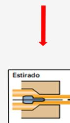
**5. Estirado:** Después de dimensionar el tubo se somete a limpieza
